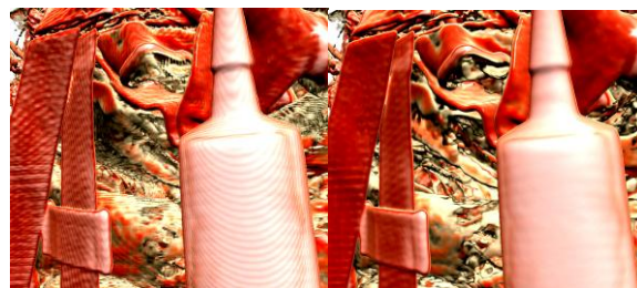
Рис. 2. Сравнение качества визуализации алгоритмом RC с трилинейной (слева) и трикубической (справа) интерполяцией.
