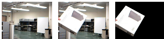
Рисунок – 1. Задача вычитания фона. Слева направо: фон, кадр с объектом переднего плана, искомая маска объекта.
