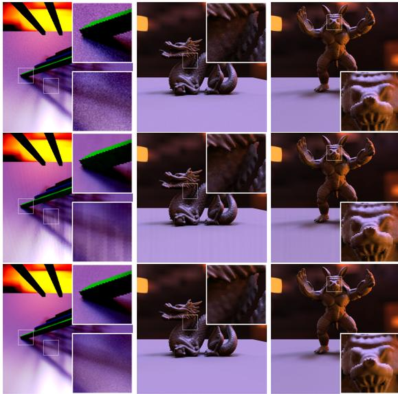
**Рисунок 2:** Сравнение качества изображений для выборки пропорционально ДФО  $64 \times 64$  лучей (первая строка), алгоритма репроекции (вторая строка) и алгоритма репроекции с последующей выборкой по значимости еще  $64 \times 64$  лучей (третья строка)
