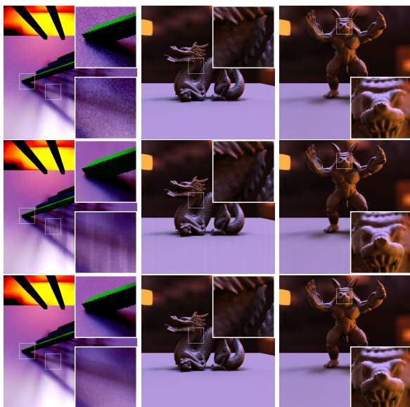
Рисунок 2: Сравнение качества изображений для выборки пропорционально ДФО 64 × 64 лучей (первая строка), алгоритма репроекции (вторая строка) и алгоритма репроекции с последующей выборкой по значимости еще 64 × 64 лучей (третья строка)
